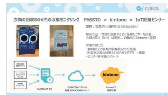
衣類回収BOXを活用したIoTセンサー実証実験
